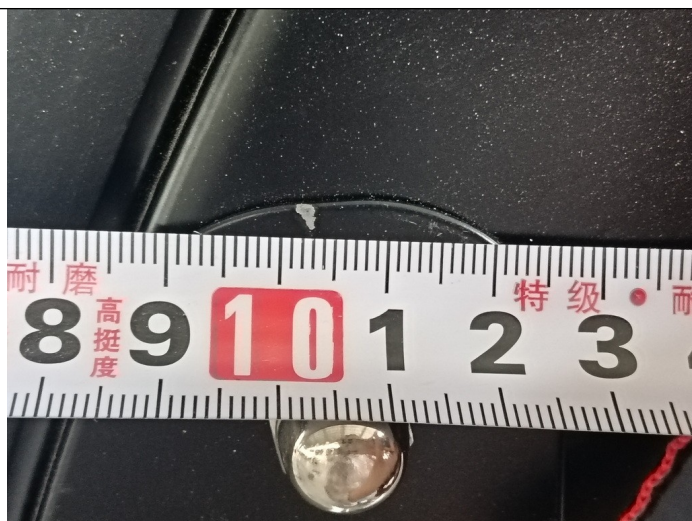
Pintura mal feita na porta (3 mm) - Pequeno defeito
